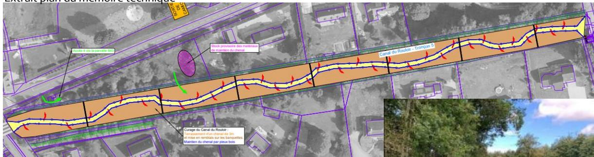
Le nouveau chenal va être creusé dans la vase. Celle-ci va être déposée sur les côtés afin de former des banquettes. Un géotextile et petit cordon de pierres retiendront les vases le temps de la solidification complète. Le canal a été mis à sec depuis février 2023 afin d'avoir un matériau déjà bien ressuyé. Cette rechenalisation concerne 800 ml du canal.
